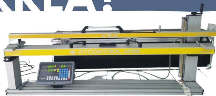
Instrumento patrón para calibración de peraltes en reglas férrea. Fotografía: SmartLab
